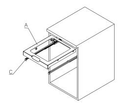
4. Fixe a chapa metálica utilizando a ferragem (G) e realize o aperto com a chave allen (0). Utilize o parafuso adequado ao modelo de corrediça escolhido, conforme tabela abaixo:
