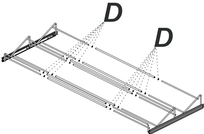
**4** Encaixar o conjunto montado no passo anterior à parte externa das corrediças já fixadas no módulo.
