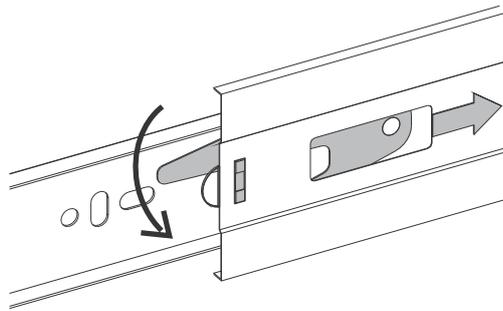
**2** Prender a parte externa da corrediça no módulo utilizando a ferragem "A", caso sejam necessários os espaçadores, utilize "B" e "C".
