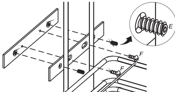
**3** Desmontar a corredeira baixando o engate, como mostra o detalhe.
