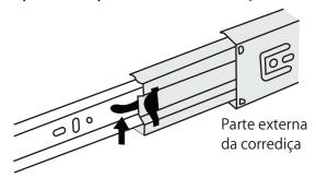
Prender a parte externa das corrediças no módulo com a ferragem A na marcação feita no quadro "3"
