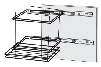
Separar novamente a corrediça baixando o engate para parafusar a parte externa da corrediça no módulo.
