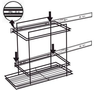
Colocar novamente a parte externa da corrediça na interna que esta parafusada no aramado e posicionar no módulo para fazer a marcação da furação
