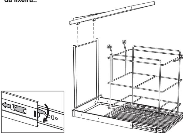
**2** Prender o carrinho no módulo utilizando a ferragem "A" respeitando a distância de 10mm entre a base do módulo e a base do carrinho.
