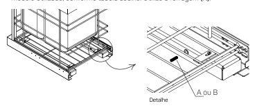
IMPORTANTE: Após o contato do parafuso com a corrediça, realize um aperto de 180° (meia volta). A aplicação do rosqueamento adicional expõe o mecanismo ao risco de danos que podem comprometer seu funcionamento
