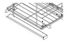
4. Encaixe a lixeira com as capas na corrediça com o parafuso adequado ao modelo utilizado, conforme tabela abaixo. Utilize a ferragem (K):
