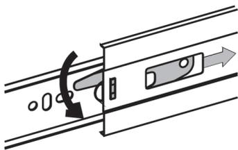
**2** Prender a parte interna da corredeira no aramado utilizando as ferragens B e E.
