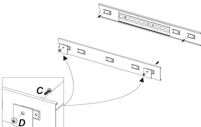
**4** Prender o carrinho na base do módulo utilizando a ferragem A.
