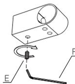
3. Encaixe o tubo na ferragem (D) e prenda com as ferragens (E) e (F).
