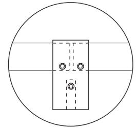
Encaixe os tubos até a metade do suporte e após fixe com os parafusos (E).
