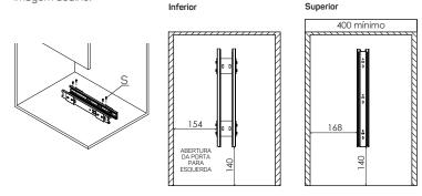
7. Introduza a estrutura no módulo encaixando as corrediças.
