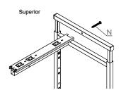
5. Realizar a montagem dos terminais (Q) e (R) conforme desenho abaixo:
