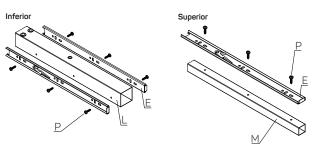
4. Faça a fixação dos montantes de união (L) e (M) no montante coluna maior (B) usando a ferragem (N).
