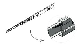
2. Fixe a chapa externa da corrediça (E) na chapa U (D) utilizando as ferragens (F) e (G).
