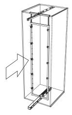
8. Para fazer o ajuste de altura do montante extensor (H), coloque o parafuso tellep (I) no montante conforme indicado na imagem, use a chave (J) e faça o aperto total depois de montada no móvel.
