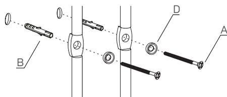
3. Para fixação no móvel: Parafuse no móvel com as ferragens (C) e (D) conforme o desenho abaixo:
