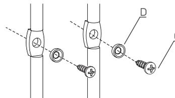
4. Após finalizar a instalação, coloque a ferragem (E) na arruela roscada (D) para dar acabamento ao parafuso.
